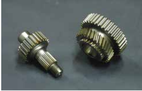
⑤ トランスファーDOWNギア
