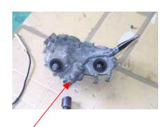
スピードメーターギアを外しシフトセンサー シャフトボールを抜き取ります。 その際シャフトボールをなくさないように注意して下さい。
