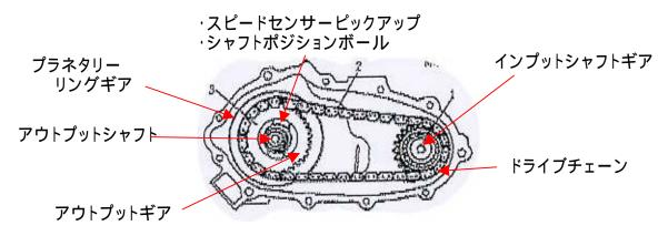
、スピードセンサーピックアップを外します。スピードメーターギアを外しシフトセンサーシャフトボールとシャフトポジションボールを抜き取ります。 注意:その際シャフトボールとシャフトポジションボールをなくさないように注意して下さい。
