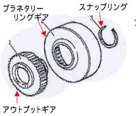
、プラネタリーリングギアからスナップリングを外しZEALのアウト プットギアを取り付けて下さい。
