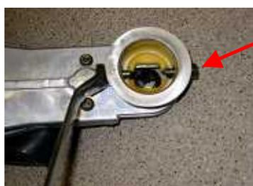
3 シフトケースの前後のネジを外し中のプラスチックカバーを外して下さい。外した後ネジは元の位置に戻して下さい。
