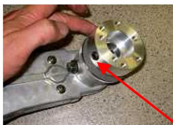
4 次に先程の逆の要領でアルミの台座にスチールのリングを入れミッションケースに差し込み台座を回して切り込みにネジを引っ掛けて下さい。
