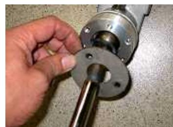
7 平スプリングを入れてから丸カバーで押えてネジで固定して下さい。
