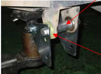
次にシャックル部の取付です。リーフマウントの間に付属のスリーブを挟み、図のようにシャックルプレートとマウントの外側にウレタン製スペーサーを挟んでボルト&ナットで固定します。(仮締め)
